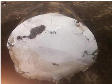
图 1 轧辊辊身断裂
