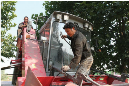
图 3 工作人员检验螺栓松紧度
