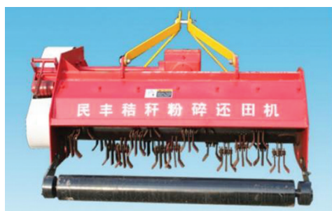
图 7 甩刀式秸秆粉碎还田机
