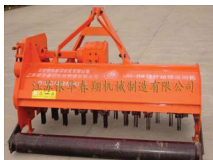
图5 直刀式秸秆粉碎还田机
