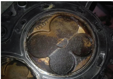
图2 漏油故障
