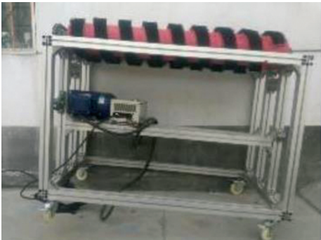
图 2 双螺旋毛刷清洗机
