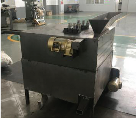
图 3 核桃喷砂清洗机
