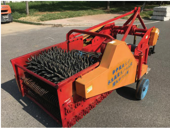
图 1 4BG-900S 型荸荠采挖机
